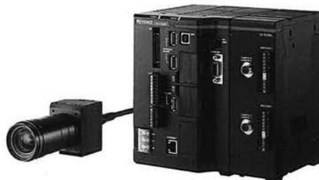
写真1 XG-X2900 & 8K ラインカメラ
