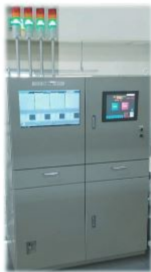
写真6 マルチ検査用制御盤 (参考)
