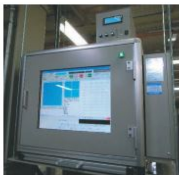
写真5 ラップフィルム検査装置設置例
