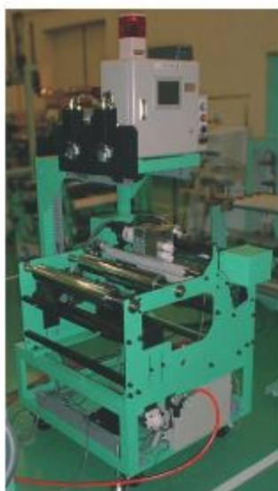
写真3 簡易移動式検査装置
